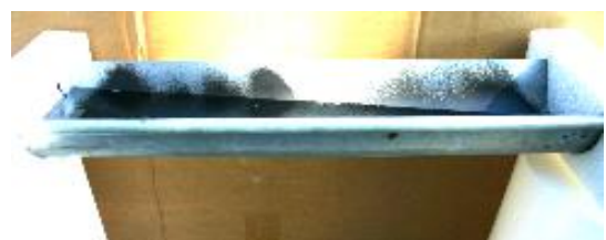
Après séchage : Les fuites sont obturées
